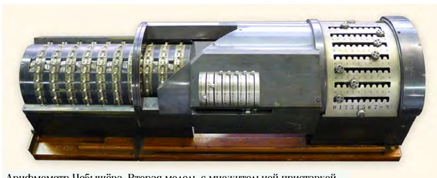
Арифмометр Чебышёва. Вторая модель с множительной приставкой
