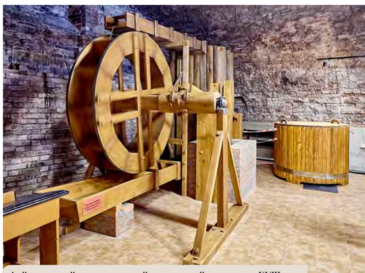
Действующий макет водяной молотковой мельницы XVIII в.
